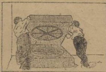
4. — Обидві рямці, наповнені піском, на деякий час одділяють, щоб вииняти деревяний зразок колеса.
