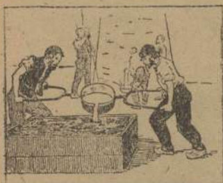
5. — Верхні рямці ставлять на місце і крізь дірочки ллють розтоплений метал в простір, що лишається незайнятим після того, як ми взяли моделью.
