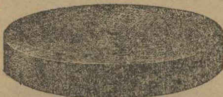
Мал. 158. — Жорен млиновий, якого готують з дуже твердого каміння, яке звється пісковцем.
