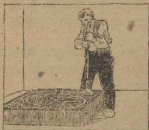
1. — Робітник намагає піску в рямці довкола зразка колеса (моделі), зробленого з дерева.
